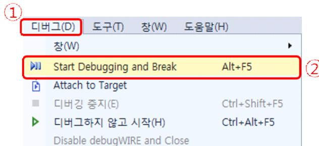
(16) 빌드된 프로그램이 PC에서 ATmega328PB XMINI board로 다운로드 되고 나면, 화면이 debugging을 위한 상태로 전환된다. 아래의 그림과 같이 프로그램이 다운로드 되고 난 후, 프로그램의 시작점인 15번 라인에서 디버깅을 위한 명령을 기다리고 있다.
